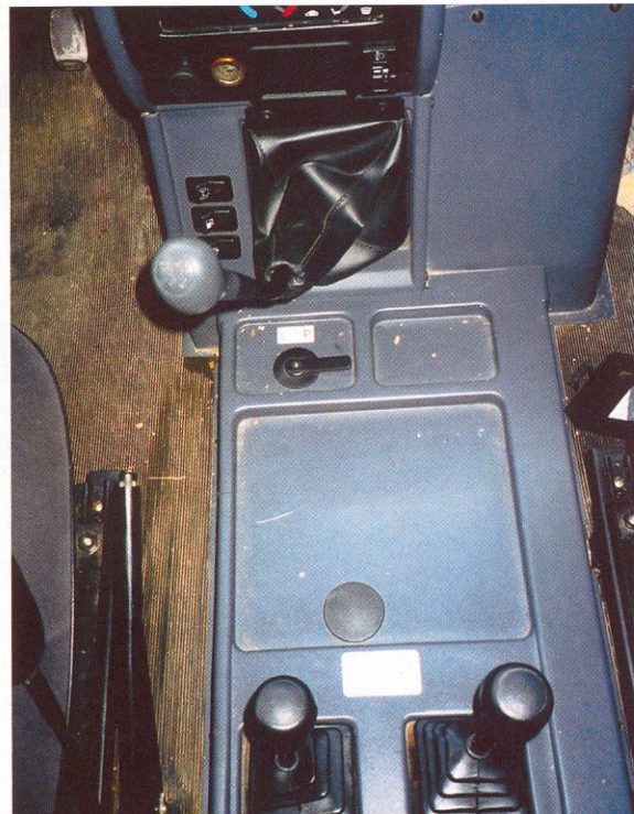
Pod dlouhou řadičí pákou je ovládání ventilů k levé a pravé nádrži. Tlačítka se ovládají elektronická uzávěrka zadního diferenciálu a elektrická čerpadla k nádržím. Krátké páky pak slouží k zařazení redukce resp. k uzavření mezinápravového diferenciálu
